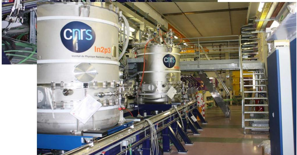
Cryomodules « B »
